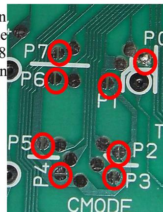
Voici le détail d'un jumper. Il est constituée de 2 zones conductrices. Si ces 2 zones sont reliées par un élément conducteur (*par exemple une soudure*), on dit que le jumper est fermé. Dans le cas contraire, on dit qu'il est ouvert. Et comme par hasard, le jumper P0 comporte une soudure...
