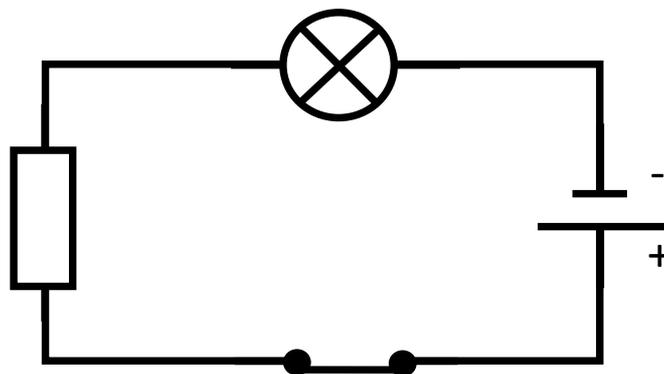
**Question 6 (4 points).** Recopier le schéma du circuit ci-dessus sur votre copie en ajoutant les schémas normalisés des appareils permettant la mesure de la tension aux bornes de la résistance et de l'intensité du courant qui la traverse.
