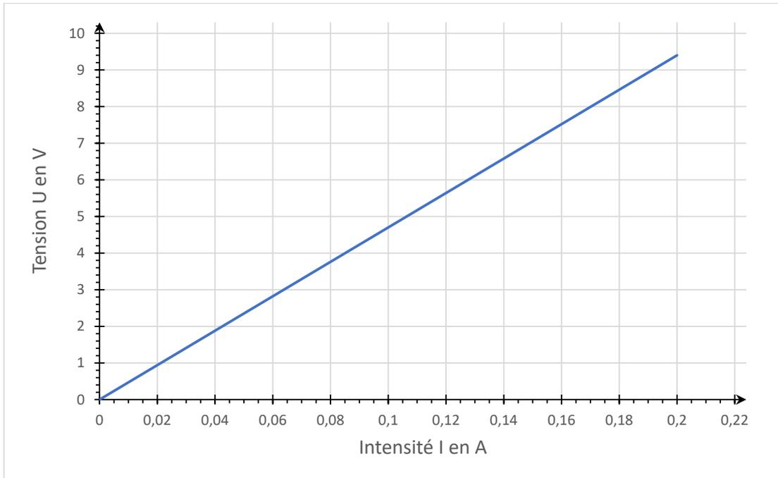
**Question 8 (2 points).** À l'aide du graphique ci-dessus, déterminer la valeur de la tension aux bornes de la résistance quand elle est traversée par un courant d'intensité de valeur égale à  $0,19\ \text{A}$ .
